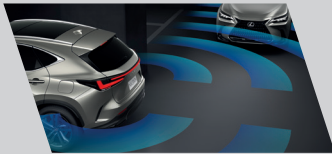
Sensores de estacionamento inteligente (Intelligent Clearance Sonar - ICS) - abaixo de 15 km/h
